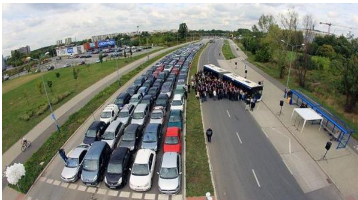
Ryc. 5. Porównanie powierzchni jezdni zajętej przez autobus miejski oraz samochody osobowe przewożące tę samą liczbę osób
